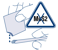
Engrase moderadamente también los cojinetes y ejes (no utilizar aceites que contengan MoS2)
