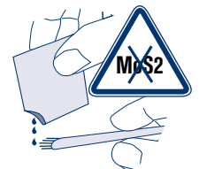
Nabe und Welle gegebenenfalls leicht einölen ( keine MoS2-haltigen Öle verwenden ).
