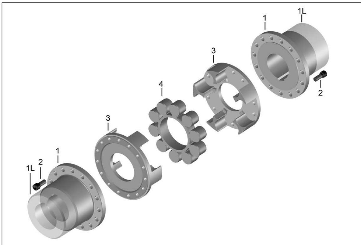
**Bild 1** Aufbau RINGFEDER® TNS SDD-5, TNS SDDL-5
