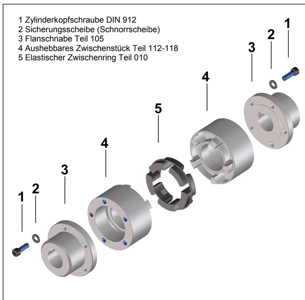
Bild 1 Aufbau RINGFEDER® TNM H
